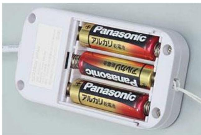
Задний отсек пульта управления закрыт сдвижной крышкой и имеет отсек для 3-х пальчиковых батарей. Можно также использовать никель-водородные батареи. Подвода питания извне не предусмотрено. Пульт управления соединяется с помощью 4-пинового штекера и метрового кабеля.
