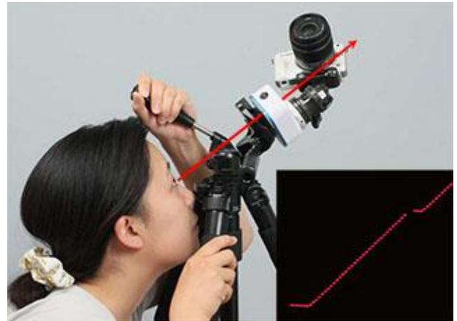
Здесь показана система в сборе. Фотограф смотрит в отверстие на монтировке и настраивает полярную ось. Чем дальше находится глаз от отверстия, тем сложнее увидеть и поместить Полярную звезду в центр отверстия. Процесс требует тренировки и усвоения эффективных приёмов.
